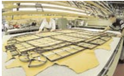
Tilskjæring/stansing av møbelhud/Leather cutting
